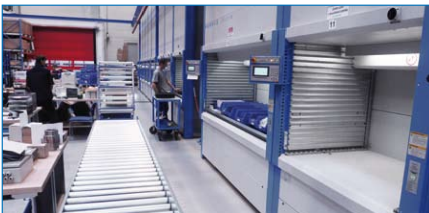
Automatizovaná zařízení doplňují dopravníkové pásy pro maximální usnadnění vychystávání.
