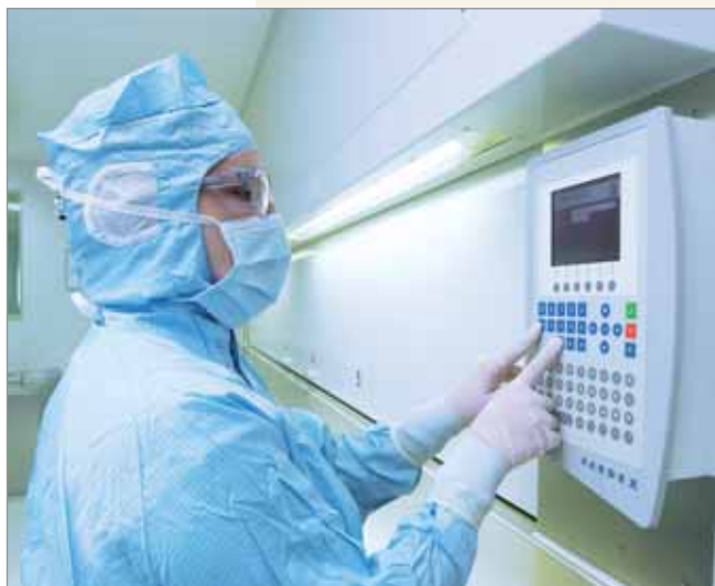
Suché skladování v řízené atmosféře s konstantní relativní vlhkostí 5%
