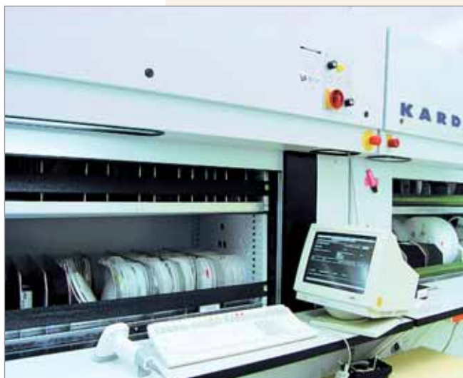
Speciální sklad tištěných obvodů u výrobní linky
