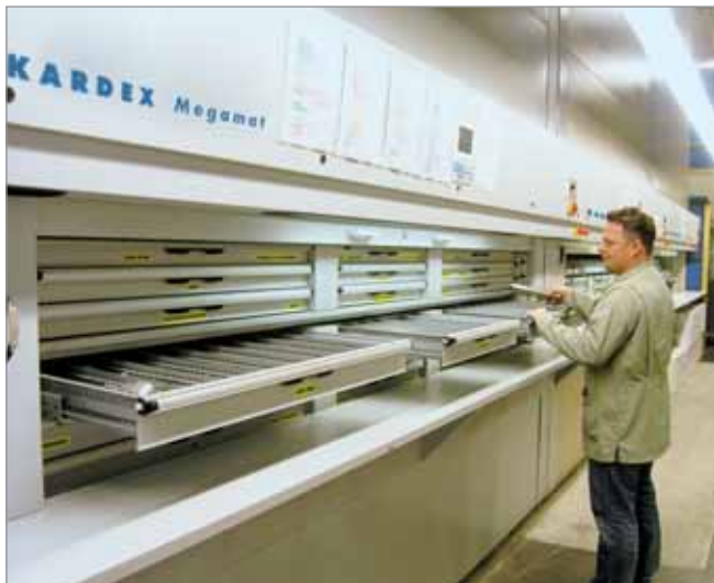
Systémy Kardex Megamat umožňují vysoce efektivní naskladňování a vychystávání zboží při maximální úspoře místa
