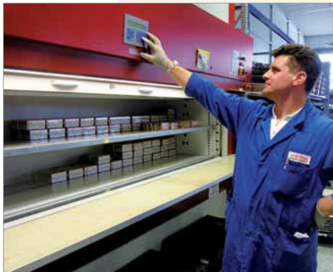
Skladování mikroprocesorů v karuselu verze ESD s ochranou proti elektrostatickým výbojům
