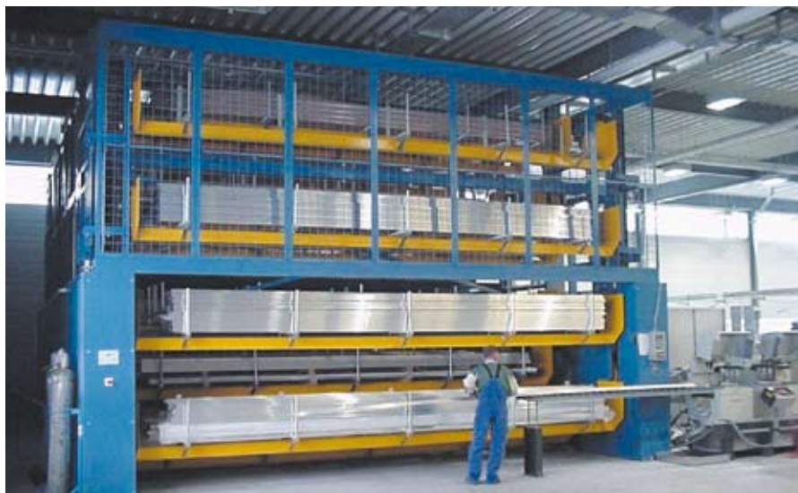
Pátersoner pro vysokou zátěž v kovozpracujícím podniku. Tady je zapotřebí rychlý přístup k nejrůznějším hliníkovým profilům.
