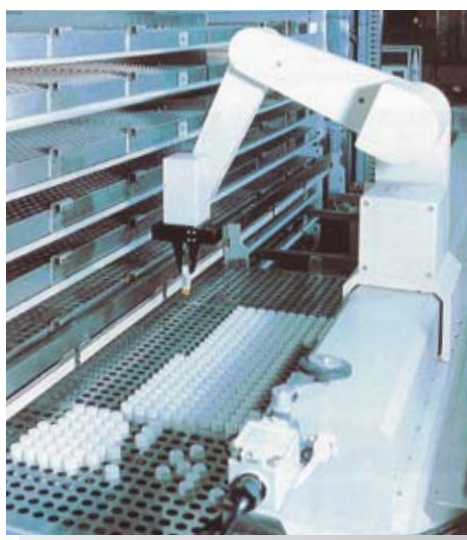
Vyjmutí ze zařízení KARDEX Industrier® obstará počítačově řízené rameno robota – plně automaticky.
